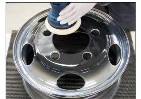
ポリッシャー施工
