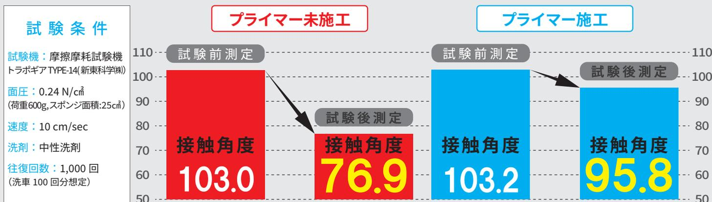
試験結果より、メッキ・金属パーツ専用プライマーを施工することで金属パーツに施工したガラスコーティングの耐久性が向上することが確認できました。
