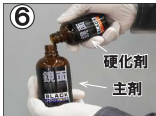
⑥ 液剤調合 主剤のビンに、硬化剤を全量注ぎます。
