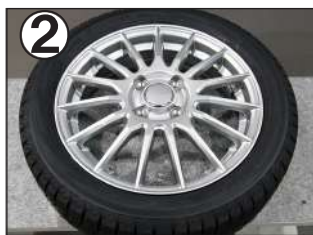
② 脱脂 汚れやキズがないことを確認して、アルコールで表面の油分を脱脂します。
