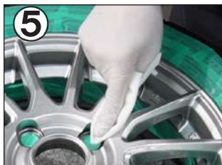
⑤ プライマー塗り込み 施工面に隙間なく塗り込み、時間を置かずコーティング剤を塗り込みます。
