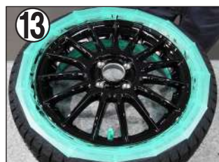
⑬ 乾燥・養生除去 コーティングが固まると養生が剥がしにくくなるので約3時間の指触乾燥後、施工面に触れないように養生を剥がしてください。
