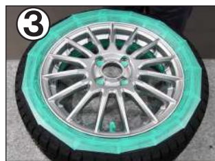
③ 養生 マスキングテープ等で施工面の周囲を養生します。
