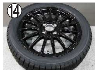
⑭ 静置 施工完了後 12 時間は水分や手で触れないように静置してください。
